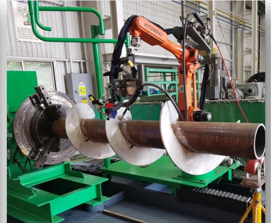
Robot 자동배관용접 M/C
